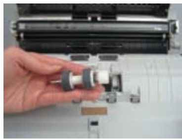
Rollen sind leicht zu ersetzen.
